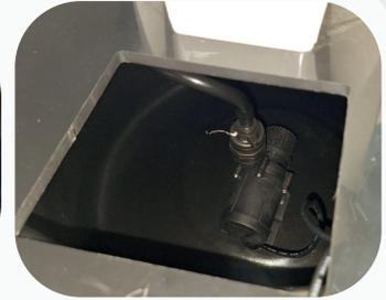
Coloque los adaptadores en la manguera que sobresale de la parte inferior de la tapa, y acople la bomba. La bomba debe quedar asegurada en el fondo del tanque con sus ventosas.
